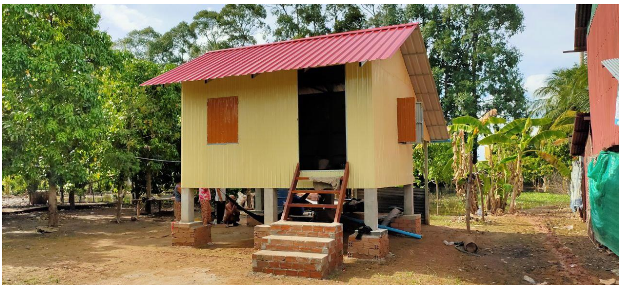
Een klein huis voor een gehandicapte moeder en haar dochter. Omdat het water hier nogal hoog kan staan in het regenseizoen zijn de pilaren opgehoogd.
